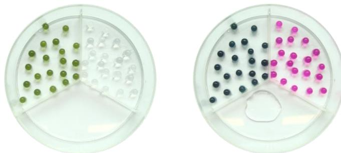
Abb.: Universalindikatorbällchen (oben links) bzw. Phenolphthaleinbällchen (oben rechts) in mit Ammoniak angereicherter Atmosphäre (links: vor Versuchsbeginn; rechts: nach ca. 2 min)
